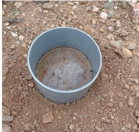
**Figure 13 : positionnement du cylindre pour le test d'infiltration de Beerkan**
