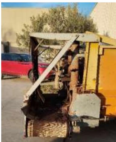
solution qui faciliterait l'épandage. Il a fabriqué un épandeur sur mesure avec un tapis qui facilite le passage du BVC, voir image ci-dessous :
