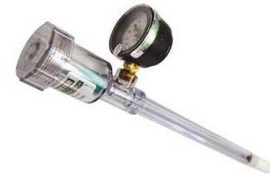
Figure 7 La réf. dont on a parlé en formation : tensiomètre à eau Irrrometer
